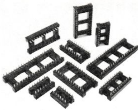
Figura 5. Se non si è ancora molto abili nel saldare, è bene ricorrere agli zoccoli per il montaggio dei circuiti integrati.
